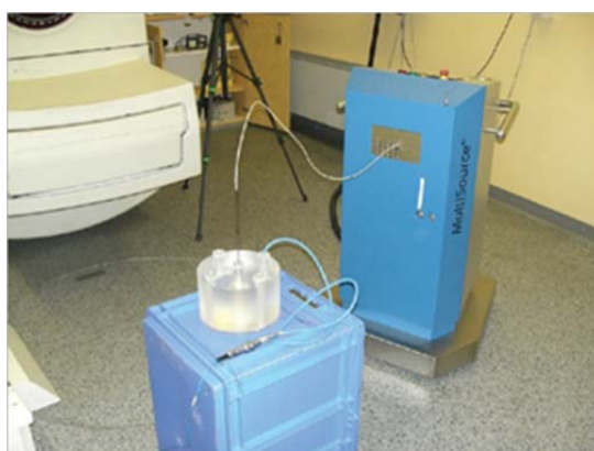
Рис. 5. Измерение мощности воздушной кермы ионизационной камерой напёрсткового типа, установленной в твердотельном фантоме PMMA 9193
