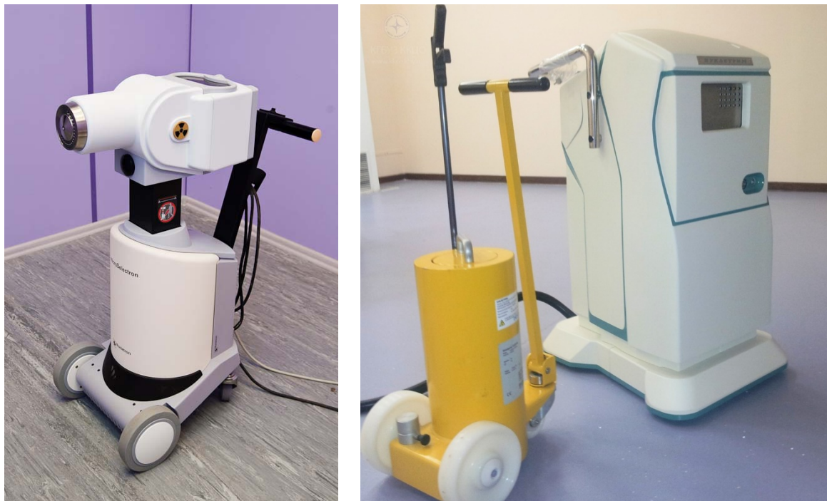
Рис. 4. Аппарат контактной лучевой терапии «MICROSELECTRON HDR» (слева); отечественный гамма-терапевтический комплекс для брахитерапии «Нуклетрим» (справа)
