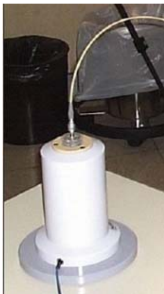
Рис. 7. Измерение мощности воздушной кермы ионизационной камерой колодезного типа
