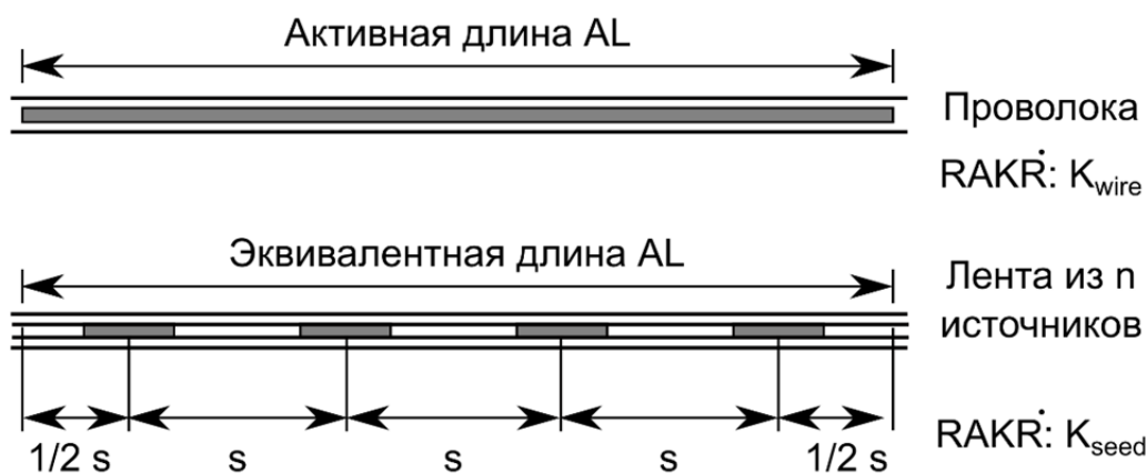
Рис. 3. К определению активной и эквивалентной длины
